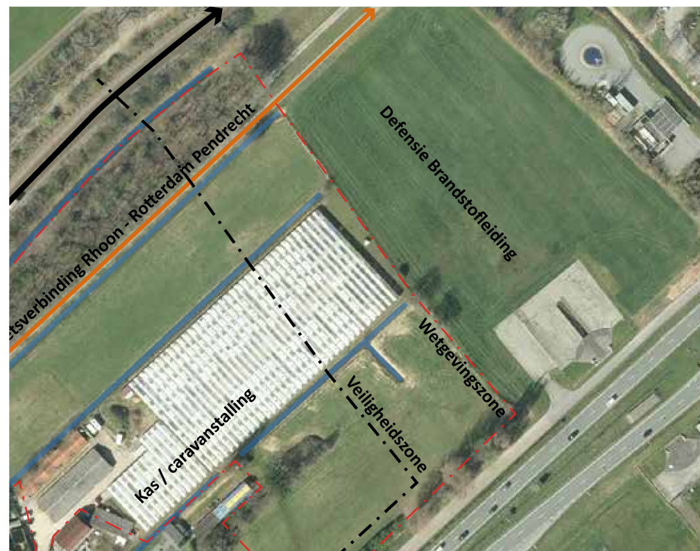
Luchtfoto met locatie brandstofleiding en veiligheidszone
