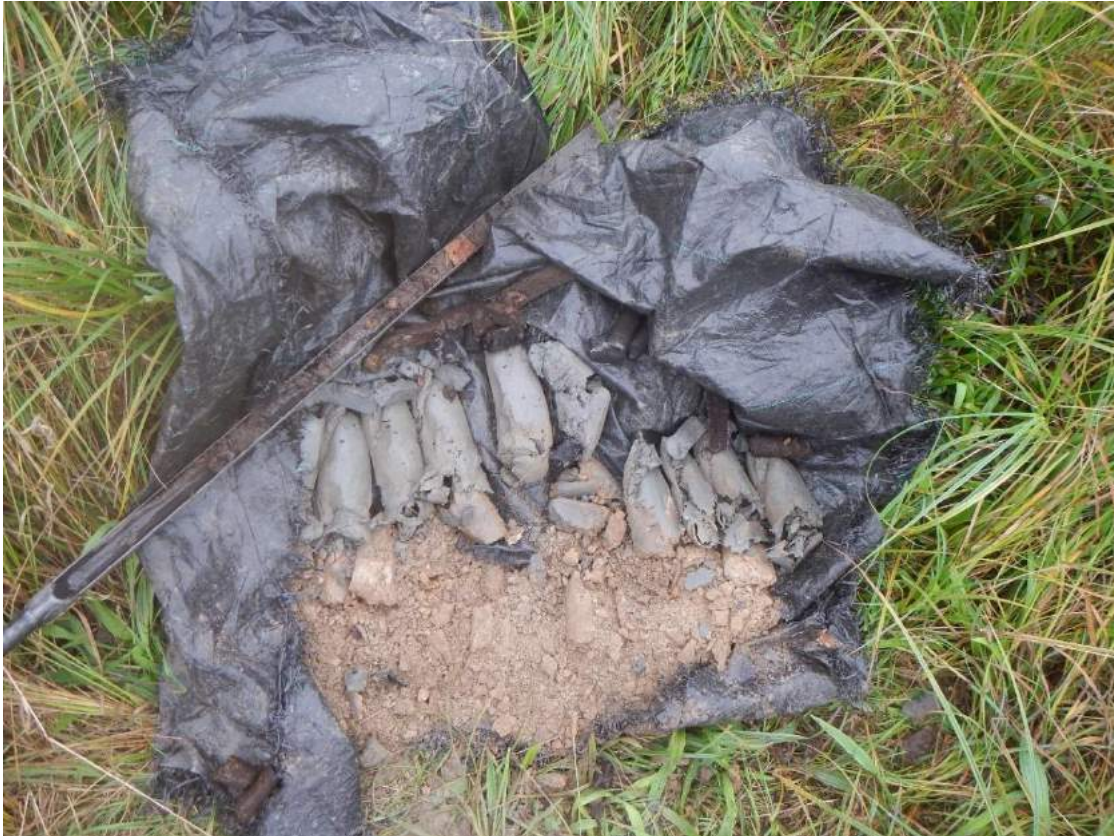
Afbeelding 5 Boring 6 uitgelegd van beneden naar boven, van links naar rechts. Het bemonsterde houtblok in de top van het Laagpakket van Wormer is in de guts zichtbaar.
